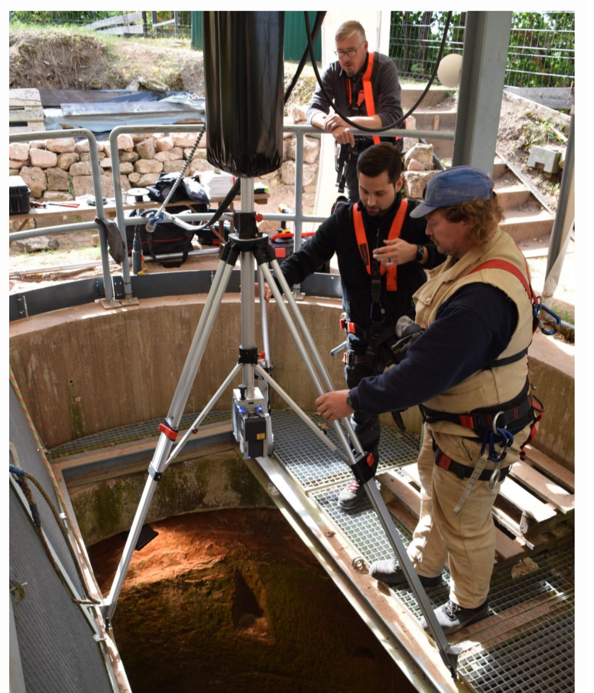
Die freigelegte Brunnenröhre wird jeweils nach 7 m Abtragstiefe im 3D Laserscan erfasst. Vermessungs-Ingenieure Patrik Schwedt, Robin Miller; rechts: Bergbau-Ingenieur Thomas Bronder †.
