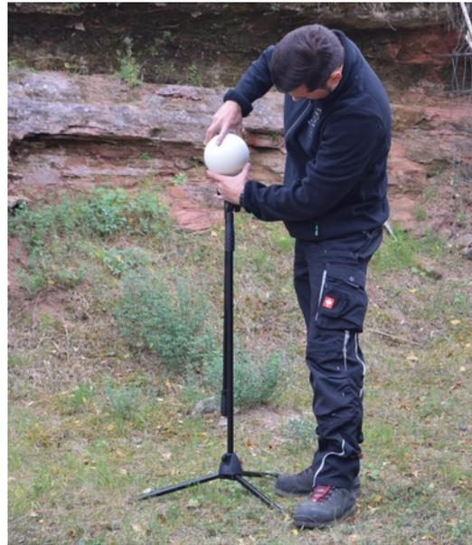
*Links: Der FARO Laserscanner FOCUS 3D X30. Robin Miller wird ein Sicherungsgurt fachmännisch angelegt. – Rechts: Vorbereiten der Scans durch Anbringen weißer Kugeln mit 14 cm Durchmesser. Sie werden an den Stahlträgern des Brunnens und im freien Gelände angebracht, nummeriert und mit der Trimble Totalstation S8 HP eingemessen. Danach dienen sie als Referenzpunkte im Scan.*
