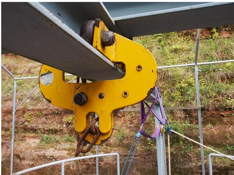
Am Galgen werden Lasten mittels einer Rollkatze Tigrip TBT40 horizontal bewegt, die für eine Traglast von max. 2 Tonnen ausgelegt ist. Das Gerät ist aufklappbar, um es leicht zu (de-)montieren. Auf dem Träger laufen vier Hartgummirollen.
