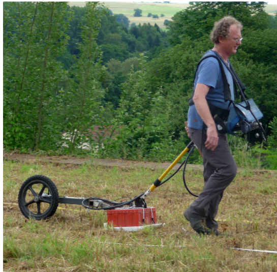
▲ Abb. 9: Christian Hübner, GGH, bei der Erkundung des Schlossbergs mit dem Bodenradar (Foto: Christel Bernard).
