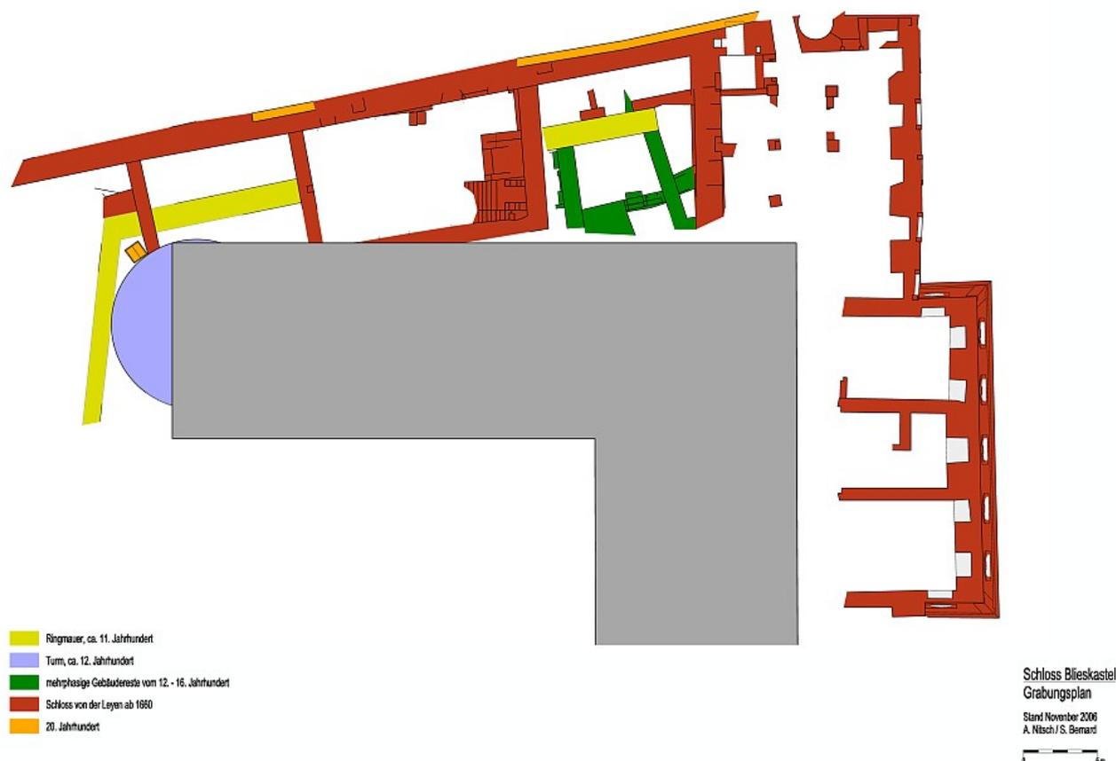
Abb. 15: Grabungsplan mit Bauphasen: Neben dem heutigen Schulhaus (grau ausgelegt) befinden sich Mauern des neuzeitlichen Schlosses (rot) sowie Teile der mittelalterlichen Burg (gelb, grün, blau). Die Fundamente des grün eingefärbten Gebäudes wurden durch die Baugrube des Schulhauses teilweise zerstört. Davon ist ein Kellerraum erhalten, dessen Mauern unter der Fläche des Schlosshofes erhalten blieben. (Schematischer Plan: A. Nitsch, S. Bernard)
